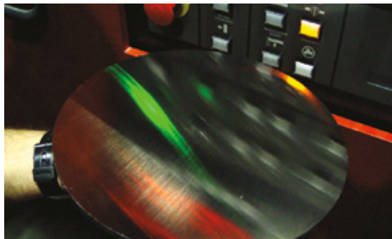
Actual SineWave finish on high nickel alloy.
